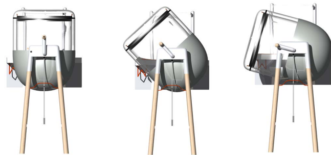
Vue de coupe de l'objet: basculement de la cuve de culture.
